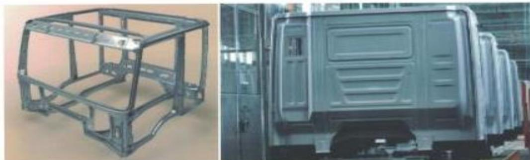
← Каркас кабины изготовлен из высокопрочной легированной стали, толщина металлического листа 1,5 мм
