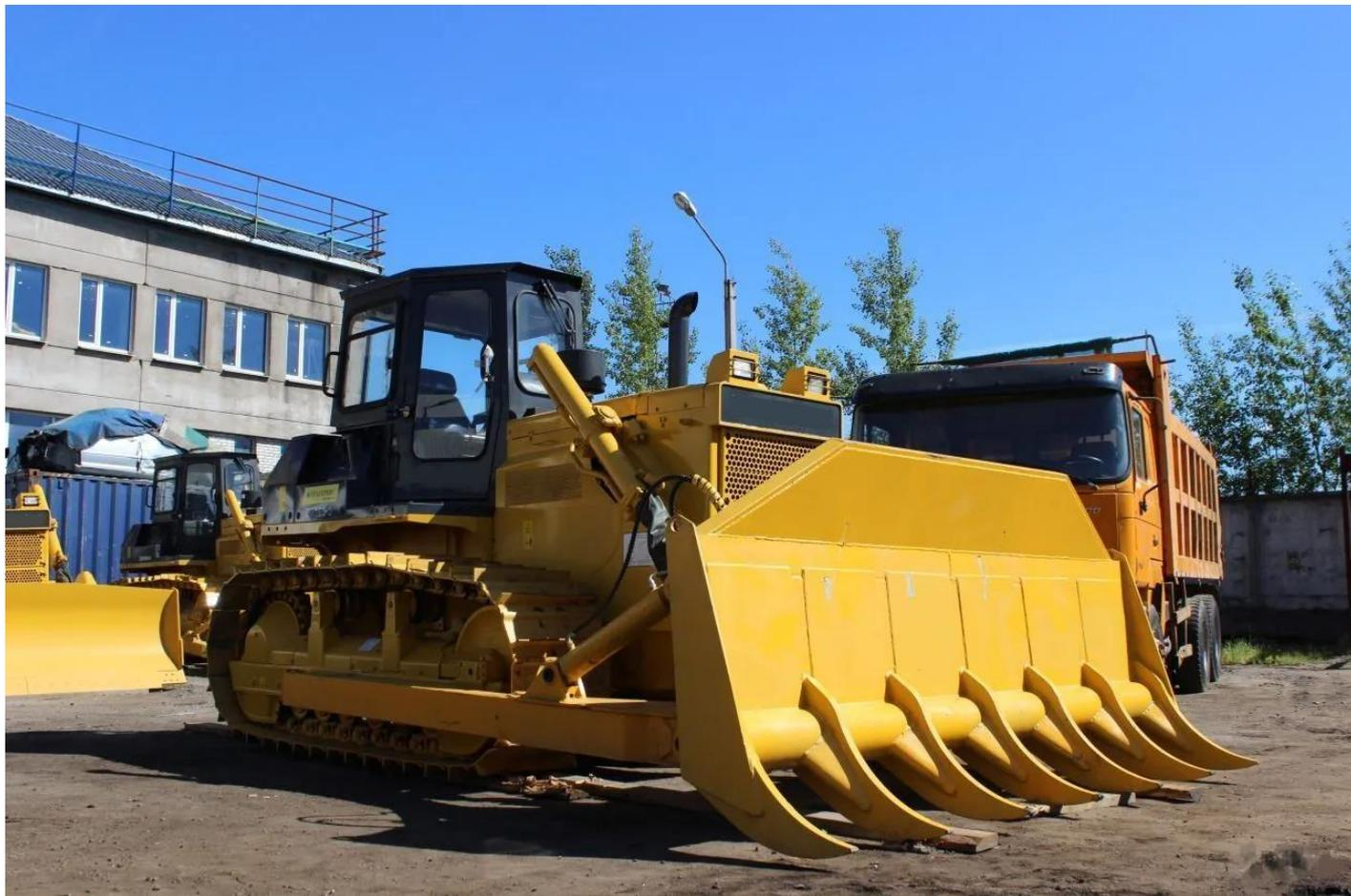
Гусеничный бульдозер BEEZONE D260 — машина оснащенная Двигателем **WEICHAI WP12G208E3304**, мощностью **280 л.с.** который обеспечивает достаточную мощность для выполнения широкого спектра работ. Бульдозеры BEEZONE широко применяются для работ на участках золотодобычи в условиях крайне сложной проходимости. Он отлично справляется как с сыпучим, так и с кусковым грунтом.
