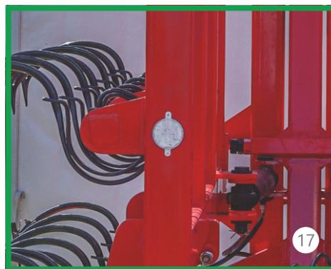
**12.** Шлейф-катки оснащены амортизационной регулировочной системой, которая нивелирует ударные нагрузки от работы катка, позволяет регулировать глубину обработки почвы. Обеспечивают дробление, выравнивание и мульчирование верхнего слоя почвы по всей ширине захвата орудия.
