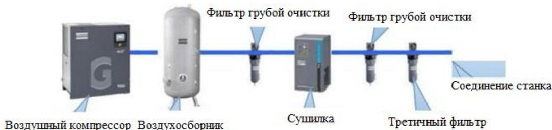
Примечание: Если воздушная резка используется часто, то для достижения лучших результатов резки пользователям рекомендуется добавить устройство холодной сушки (как показано на рисунке); устройство холодной сушки может производить сжатый воздух под необходимой точкой росы. Таким образом, большое количество водяного пара и масляного тумана, содержащихся в нем, конденсируются в жидкие капли, отделяются газом и жидкостью, выпускаются из сушилки, а сжатый воздух высушивается.
