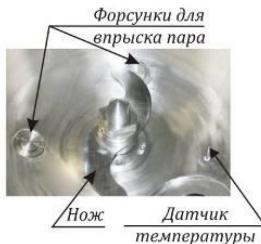
Быстросъемная улучшенная режущая насадка
